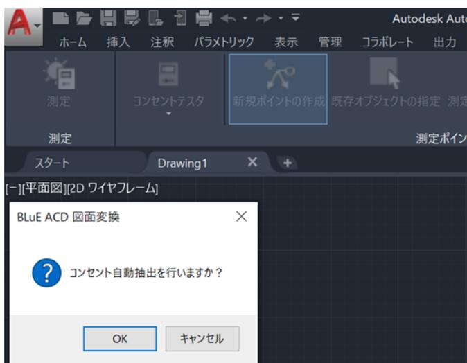
(4-1) 前述の図面変換ダイアログにて OK ボタン押下時、コンセントテストの測定ポイントを検索し、最終確認のダイアログを表示します。
