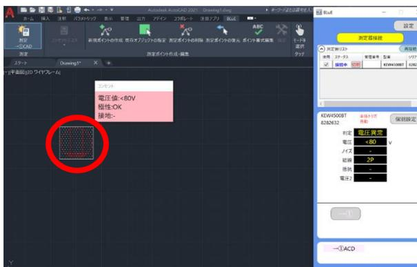
(4) 測定結果の描画ルールがデフォルトでは、「ツールチップ」に設定されているため、測定結果はツールチップで表示されます。「ポイント書式編集」もしくは、「設定」で「引出線」に変更することができます。
