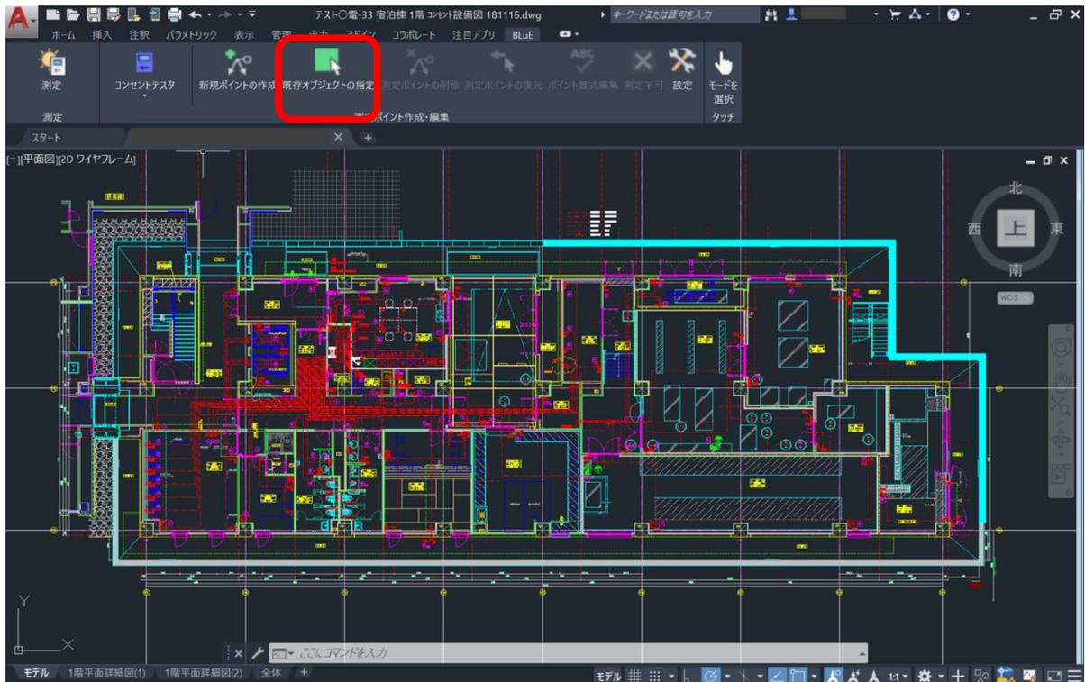
押下すると、図面上に描かれているコンセントシンボルの自動抽出を行うダイアログが表示されます。「OK」ボタンを押下します。
