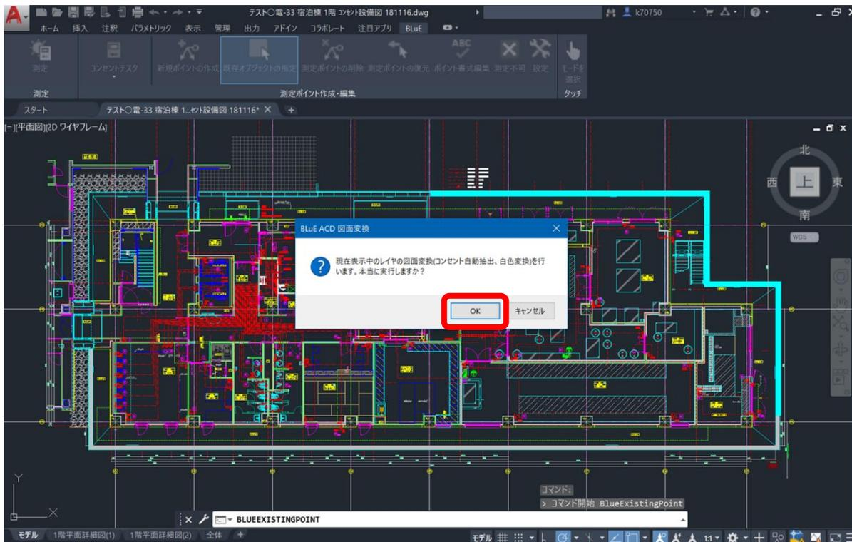
しばらくすると、コンセントシンボルだけが黄色で表示され、それ以外は白黒変換されます。(図面自体のデータ容量によって、変換時間が異なります。)
