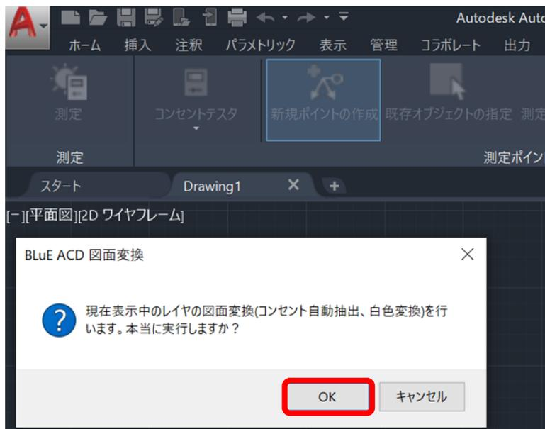
(4-2) 前述の図面変換ダイアログにてキャンセルボタン押下時、コンセントテストのレイヤを追加する最終確認のダイアログを表示します。
