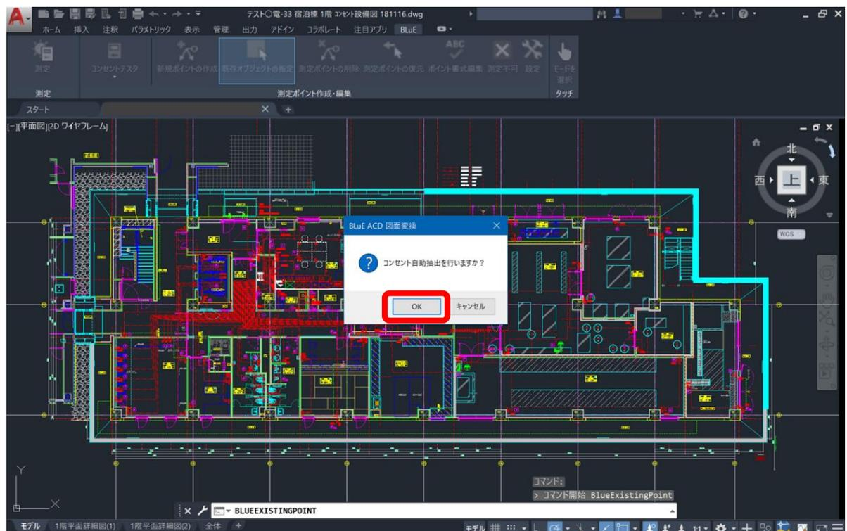
押下後、自動抽出したコンセントシンボル以外を強制的に白黒変換する旨のダイアログが表示されます。「OK」ボタンを押します。
