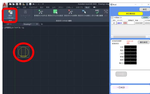
(2) 網掛けされた測定ポイントをピックすると、網掛けが青色に変化します。測定器の測定ボタンを押下すると測定ポイントに対して測定値が反映されます。
